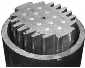
Разрез испарителя «Торгехх» (сухой электрический)
